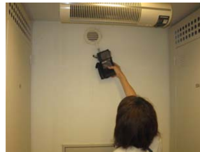
ニオイセンサーにて臭気強度の測定
