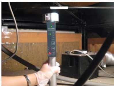
エアーサンプラーを使用し空中浮遊菌を採取
