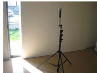
三脚に取り付け空中浮遊菌を数分間採取
