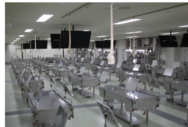
▲局所排気装置付解剖実習台
