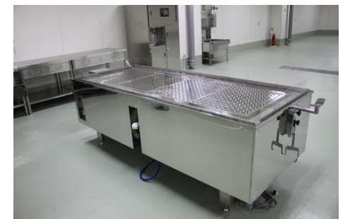
▲局所排気装置付献体処置台(処置室向)
